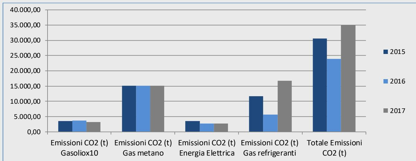
Da evidenziare l'aumento della quantità totale di co2 eq a cui ha contribuito in modo significativo il reintegro di gas refrigerante a causa di perdite importanti su alcuni impianti e della rottura di una tubazione presso lo stabilimento di Bolognana (quest'ultima con una perdita di circa 1000 kg di R404a pari a circa 4000 TCO<sub>2</sub>eq
